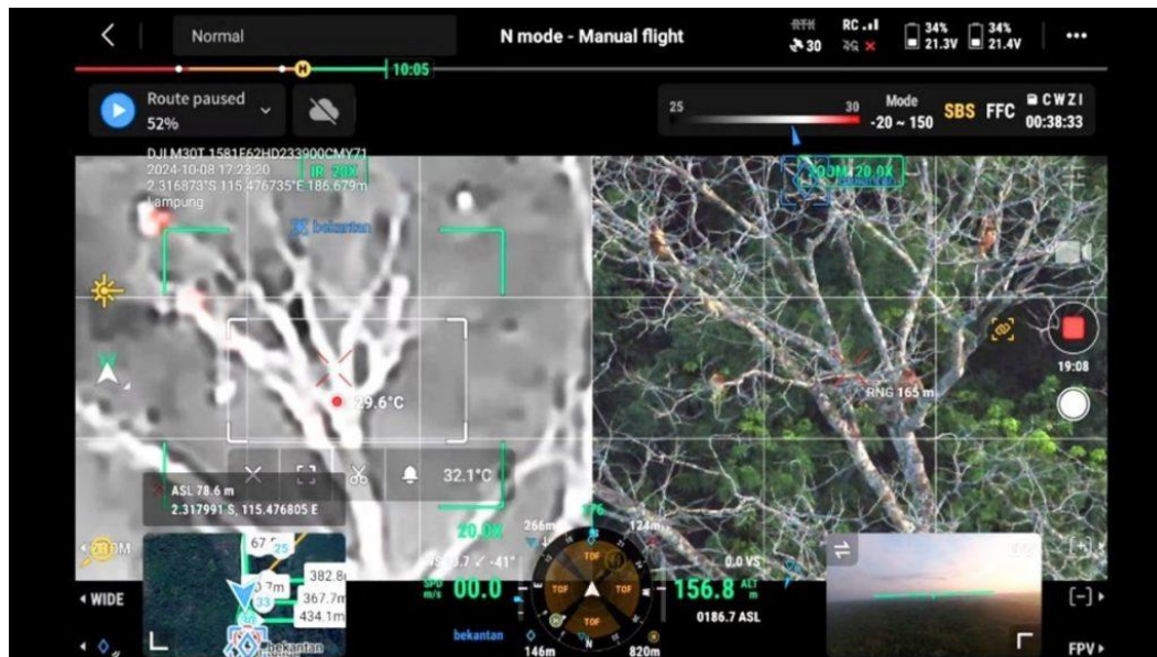
Gambar 11 Kombinasi teknologi lingkungan, Biologi dan Teknologi Informatika, kamera thermal yang terpasang di drone [9]
